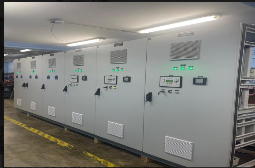
Fabricación de tableros eléctricos
